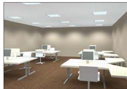
Рис. 3 Офис, освещение с помощью прибора PTF/R 414, расставленный полем UGR < 10, E ср = 460 лк, удельной мощности 11,49 Вт/м 2
