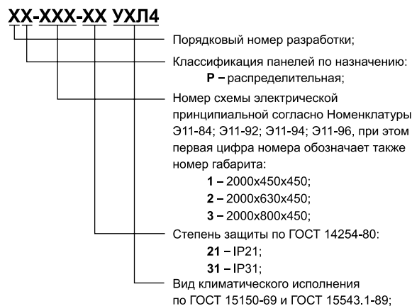
Рис. 2.2 Структура условного обозначения распределительных панелей устройств серии ВРУ85хх
