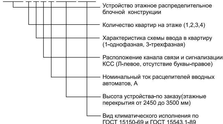
Рис. 10.1 Структура условного обозначения щитков этажных серии УЭРМ
