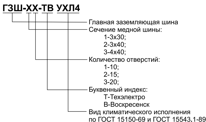
Рис. 19.1 Структура условного обозначения щитков серии ГЗШ
