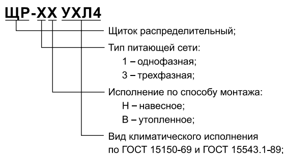
Рис. 9.1 Структура условного обозначения щитков серии ЩР
