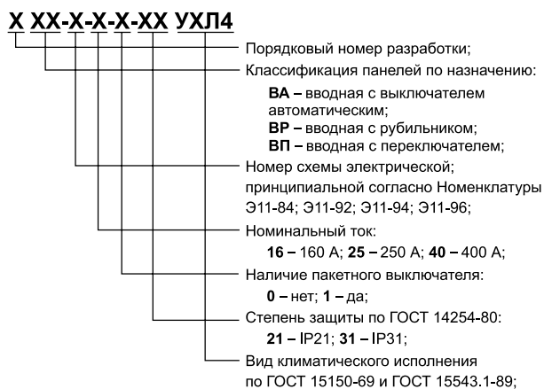
Рис. 2.1 Структура условного обозначения вводных панелей устройств серии ВРУ85хх
