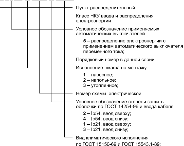
Рис. 14.1 Структура условного обозначения распределительного пункта серии ПР
