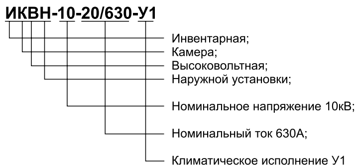
Рис. 12.1 Структура условного обозначения инвентарных камер серии ИКВН
