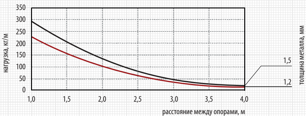
график допустимых нагрузок для лестничных лотков с высотой борта 70мм
