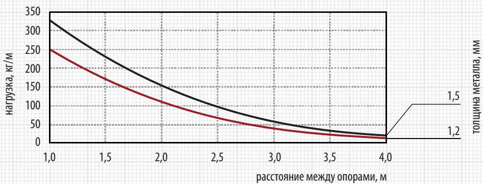
график допустимых нагрузок для лестничных лотков с высотой борта 100мм
