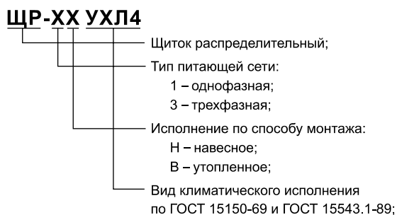
Рис. 9.1 Структура условного обозначения щитков серии ЩР
