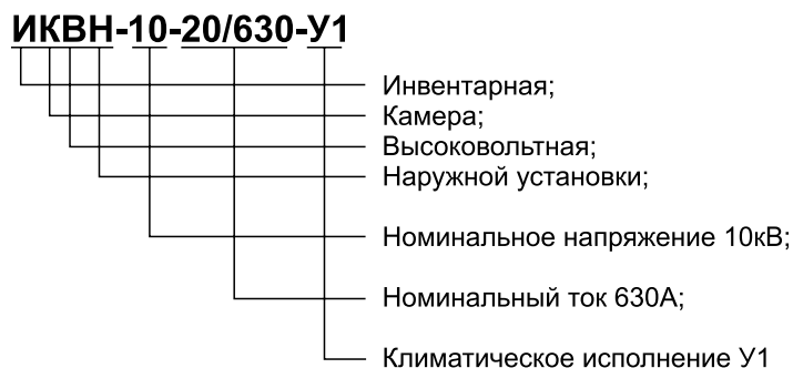
Рис. 12.1 Структура условного обозначения инвентарных камер серии ИКВН
