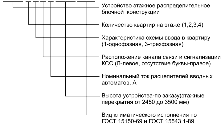
Рис. 10.1 Структура условного обозначения щитков этажных серии УЭРМ
