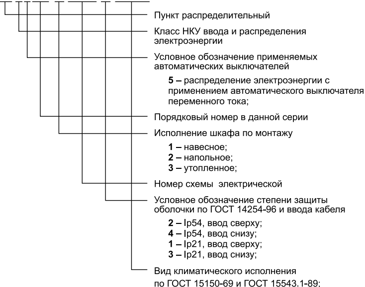
Рис. 14.1 Структура условного обозначения распределительного пункта серии ПР
