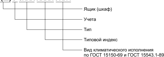
Рис. 17.1 Структура условного обозначения шкафа учета электрической энергии серии ШУ
